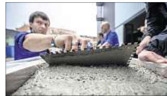
Mitarbeiter des Finger-Instituts für Baustoffkunde glätteten für das Projekt „Bamboo Concrete“ den Beton in Bambus-Halbschalen. Fotos: Candy Welz
